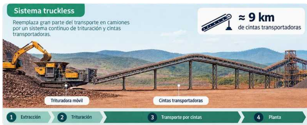
Figura 38: Funcionamiento de un sistema Truckless.
