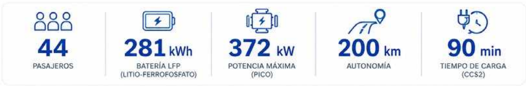
Figura 37: Características técnicas de los buses Tricahue
